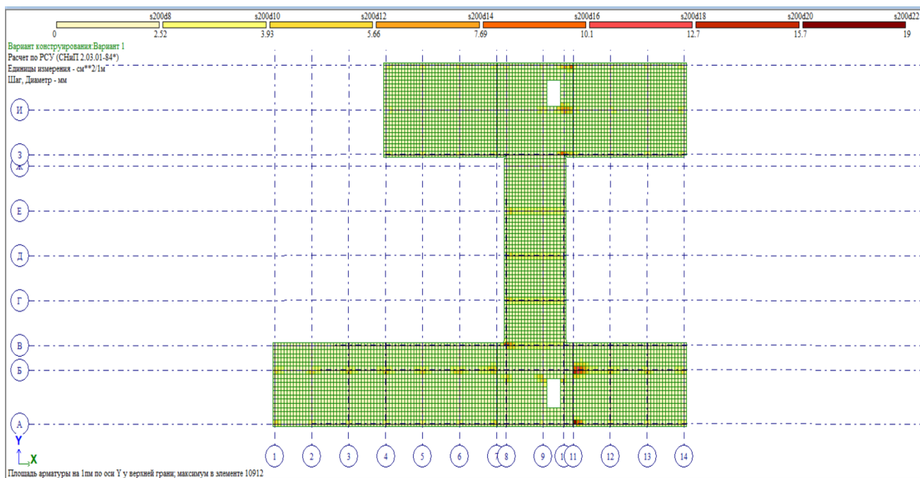
Рисунок 13 – Площадь арматуры по оси У у верхней грани в перекрытии
